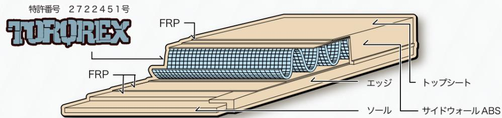
「TORQREX(トルクレックス)」は波板状の特殊ガラス繊維がウレタンと融合することによって更に反発力が増幅します。波板が伸びる事による振動吸収、更に前足だけを踏む事で推進力が得られる特許取得の特殊な芯材です。
