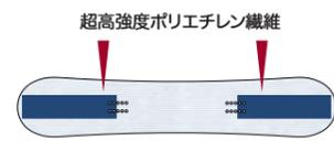
軽く! しなる! この釣り竿などに使われる素材は強力な補強材で非常に高いしなりと反発力を生み出します! 大きく影響する様に足下の外側まで長く配置。中心をカットする事によりしなやかな粘りと軽さを両立する新素材です。
