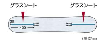
ガラス繊維素材のグラスファイバーシート補強材。たわみからの反発力が、トルクレスコアと2重になる事で更に大きな力を生み出す。
